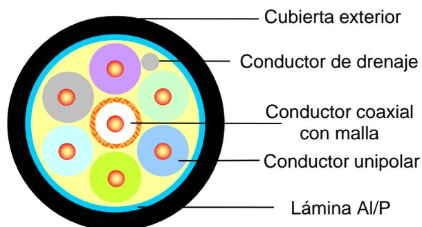
Conductores diseñados para la conexión de portero visor o cámaras de video en circuitos cerrados de vigilancia, control de accesos, monitoreo de líneas de producción, etc.
